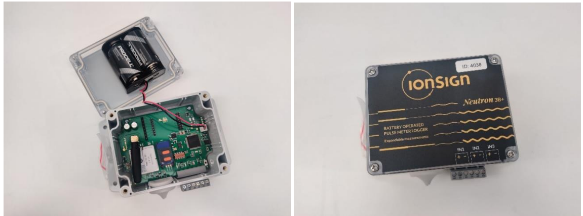
Kuvat 8 ja 9. ionSign -merkkinen pattereilla toimiva pulssikeruulaite energia- sekä vesimittareille, joissa impulssivalmius
